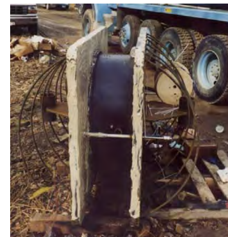
Испытание разрезного цилиндрического поперечного качающегося модуля с помощью О-селл
